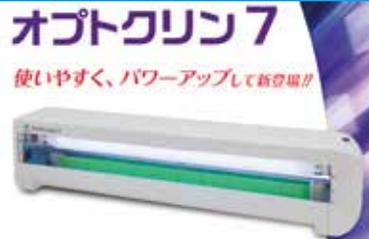
従来の捕虫器(オプトクリン)に比べ開口部を約20%広げ、捕獲力をアップ。取付方法は壁付・吊下・縦付・据え置き の4パターン。過電流時の発熱を防止する温度ヒューズを標準装備。金具類はすべてステンレス製。
